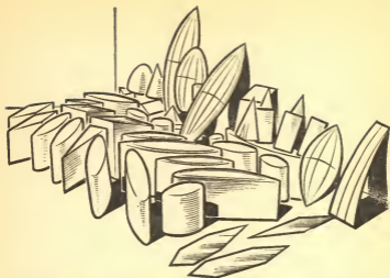
Рис. 3. Модели, обследованные К. Э. Циолковским в аэродинамической трубе в г. Калуге в 1897—1901 гг.
