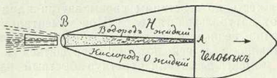
Рис. 1. Схема реактивного прибора К. Э. Циолковского
