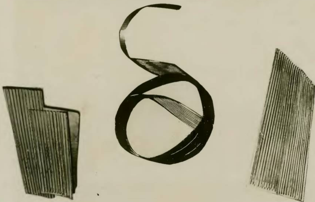
Образцы гофрированной стали, из которой К. Э. Циолковский соорудил модели своего цельнометаллического дирижабля
