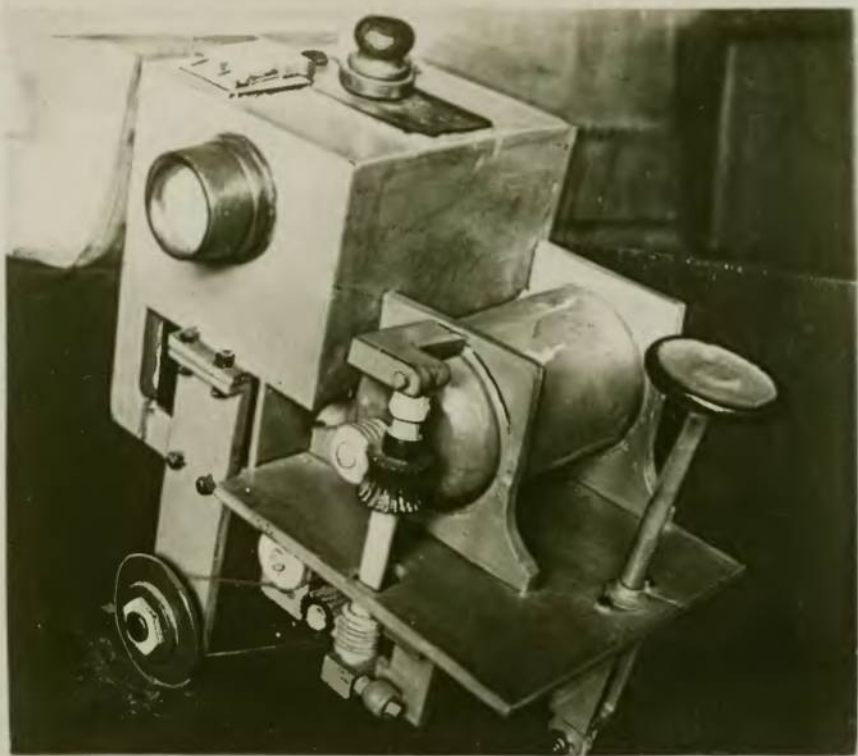
Модель роликовой электросварочной машины в половину натуральной величины
