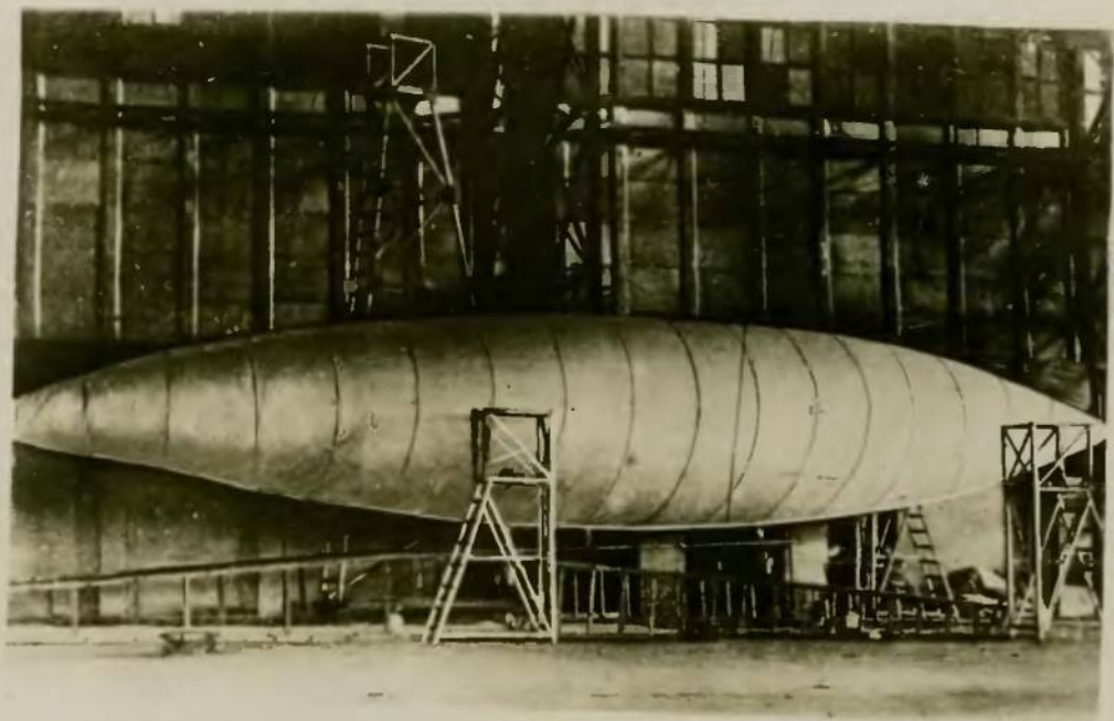
Летающая модель дирижабля системы Циолковского на статическом испытании
