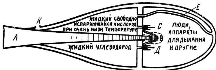
Рис. 17. Ракета Циолковского — 1915 г. Чертеж К. Э. Циолковского
