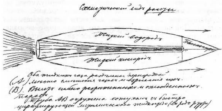
Рис. 11. Первый вариант жидкостной ракеты К. Э. Циолковского
