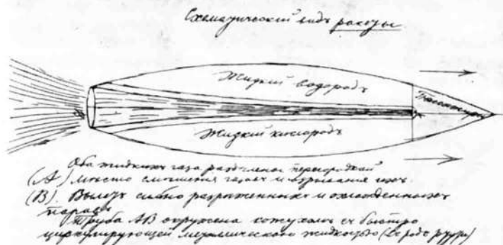
Первый вариант жидкостной ракеты К. Э. Циолковского (1902—1903 гг.). Чертежи К. Э. Циолковского
