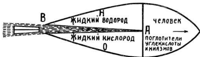
Рис. 8. Ракета Циолковского. Проект 1911—1912 гг. (с прямым соплом). Чертеж К. Э. Циолковского
